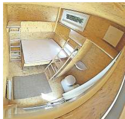
Beim Prototyp - zu besichtigen auf dem Bauhof in Nünchritz - wurden innen OSB-Platten verwendet. Die Verkaufsexemplare haben Holzmehrschichtplatten und eine geschlossene Sanitärzelle. Die Fassade ist aus Lärchenholz. Fotos: Haus 9 - Das Passivhaus
